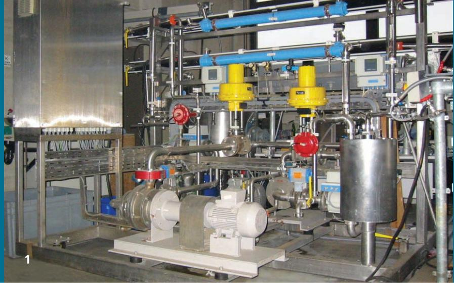
1 Kombinationsanlage NF/RO zur Nanofiltration und Umkehrosiose.
